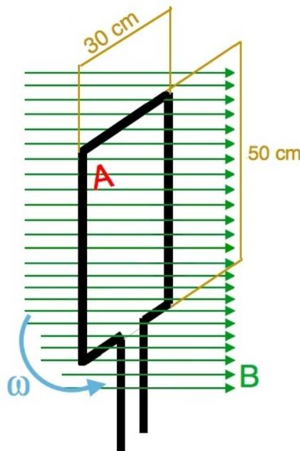
Nella figura è rappresentata una delle 100 spire (del generatore) di area  $A$  immersa in un campo magnetico costante  $B$  e che ruota a una velocità angolare  $\omega$ .
